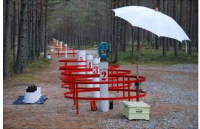
Figure V-4. The Väänä calibration baseline of the Estonian Maa-amet. (Photo: Jorma Jokela)
