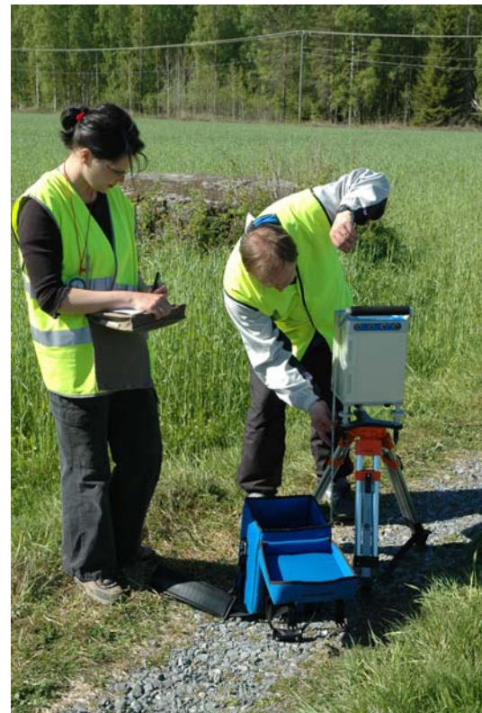
Fig. 14. Gravity measurements at the Keurusselkä meteorite impact. Photo Hannu Ruotsalainen.
